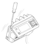
2 Retirer les capots de plombage de chaque côté du support de l'appareil à l'aide d'un objet pointu (p. ex. une alène ou une pincette).
